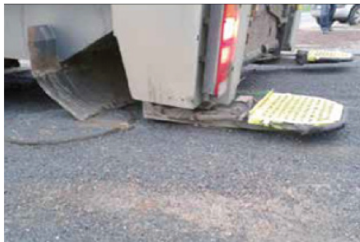
Une attention particulière sera portée au raccordement des voies. Les accès à des rues en forte pente doivent être traités pour éviter les cassures trop importantes du profil en long, entraînant une impossibilité d'accès aux véhicules de collecte (cf les caractéristiques des véhicules de collecte).
